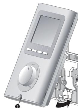
Si nécessaire, des cloisons défonçables (❷) avec une pince sont prévues pour laisser passer les câbles de raccordement si nécessaire.
